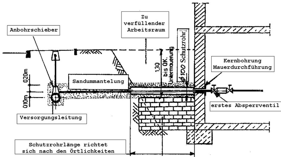
**Untermauerungen 0,60 m breit für Anschlussleitung < DN 50 z.B. aus VMz, KSVm, Hohlblocksteinen aus Beton mit geschlossenem Gefüge (Schwerbetonsteine)**
